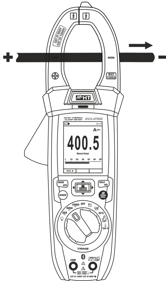
Abb. 31: Verwendung des Geräts zur Messung von DC Strom
