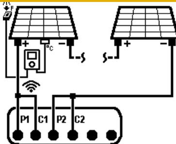
Gemäß der IEC 60904-1 wird das IV600 über eine 4-adrige Verbindungsleitung mit dem String der zu testenden PV-Anlage verbunden mit Hilfe einem CAT III 1500V-Messleitungskabel und MC4-Adapter. Durch die weitere drahtlose Verbindung mit dem externen **SOLAR-03-Datenlogger**, an dem die HT305-Referenzzelle **und der** PT3005-Temperaturfühler **angeschlossen ist, erfasst das IV600:**
