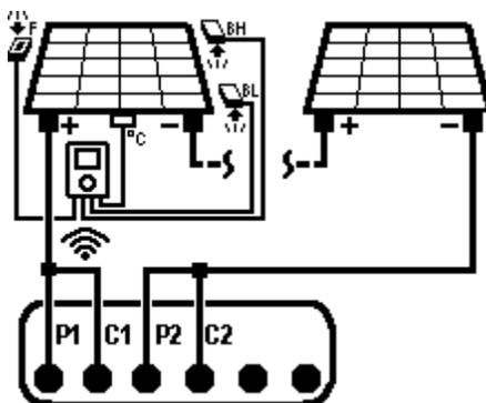
Gemäß der IEC 60904-1 wird das IV600 über eine 4-adrige Verbindungsleitung mit dem String der zu testenden PV-Anlage verbunden mit Hilfe einem CAT III 1500V-Messleitungskabel und MC4-Adapter.
