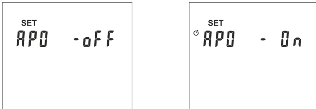
Abb. 3: Einstellung der Auto Power Off (APO) Funktion
