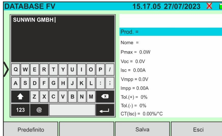
Abb. 25: Erstellung neues PV-Modul – Schritt 1
