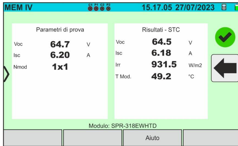
Abb. 78: Abruf der Testergebnisse IVCK @STC
