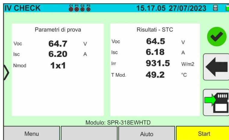
Abb. 58: Beispiel für positives Ergebnis IVCK-Test – STC-Werte
