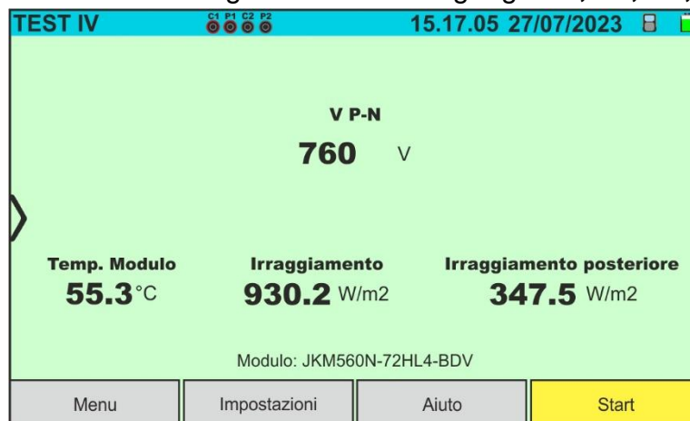
Abb. 35: Startbildschirm I-U-Kurven-Messung an doppelseitigen Modulen
