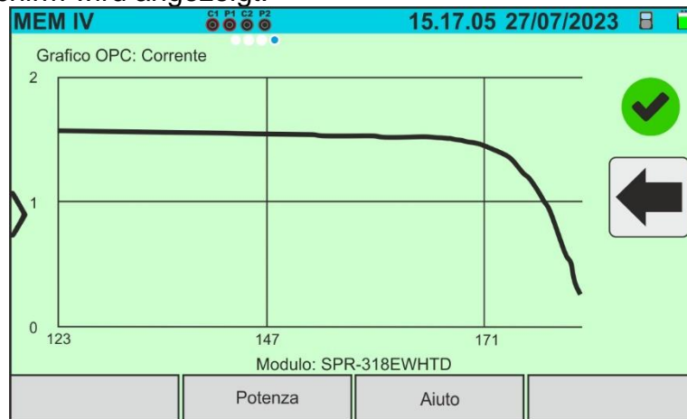
Abb. 76: Abruf der I-U-Kurven-Messergebnisse – @OPC-Stromkurve
