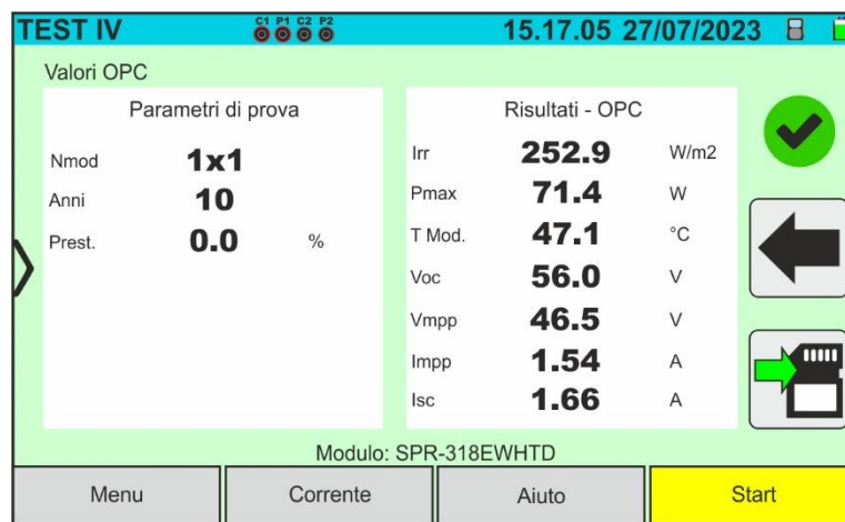
Abb. 38: Beispiel für das Ergebnis einer I-U-Kurven-Messung – OPC-Werte
