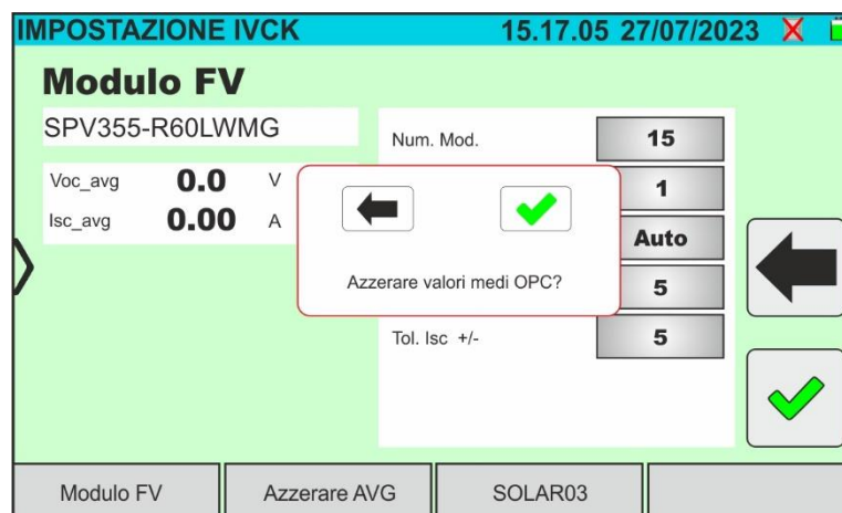
Abb. 49: Zurücksetzen der durchschnittlichen Voc- und Isc-Werte im IVCK-Test
