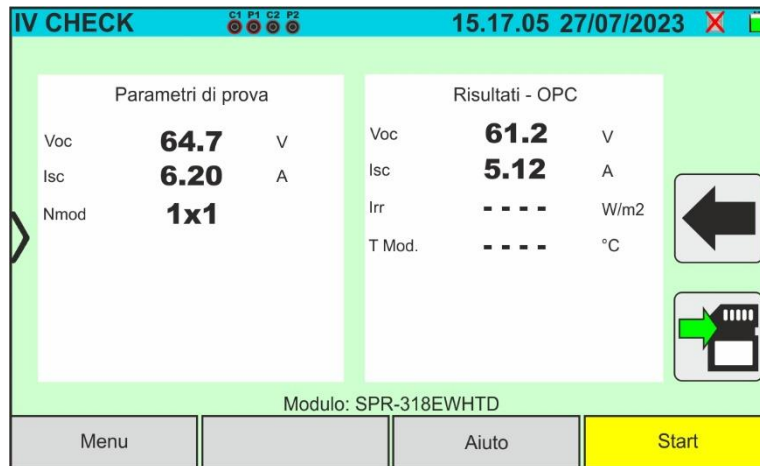
Abb. 60: Messergebnis IVCK @OPC-Test mit synchroner Aufzeichnung
