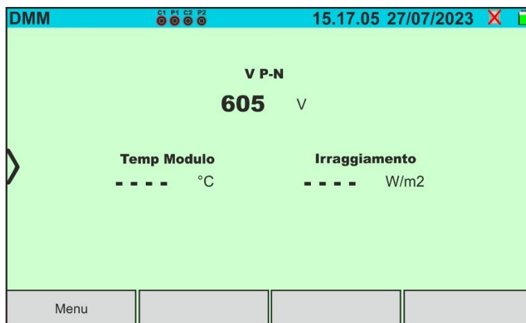
Abb. 14: Messbildschirm DMM-Funktion (SOLAR03 nicht verbunden)
