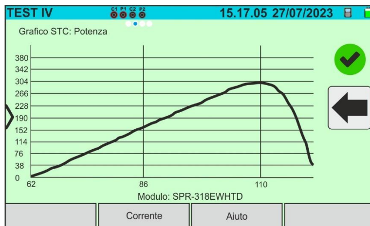
Abb. 74: Abruf der I-U-Kurven-Messergebnisse – @STC-Leistungskurve
