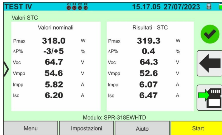
Abb. 37: Beispiel für das Ergebnis einer I-U-Kurven-Messung – STC-Werte
