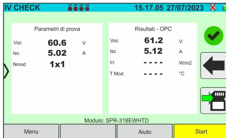
Abb. 50: Beispiel für positives Ergebnis IVCK-Test – OPC-Werte
