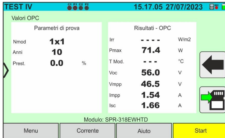
Abb. 43: Ergebnis der I-U-Kurvenmessung @OPC mit synchroner Aufzeichnung
