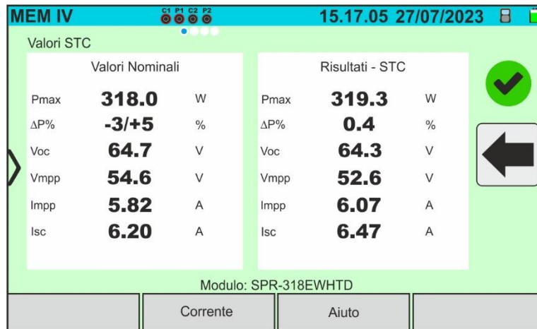
Abb. 72: Abruf der I-U-Kurven-Messergebnisse – @STC-Werte
