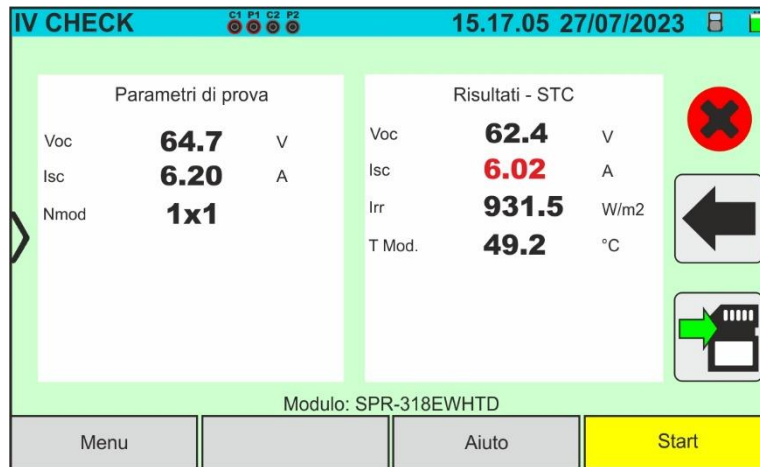
Abb. 59: Beispiel für negatives Ergebnis IVCK-Test – STC-Werte
