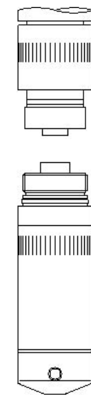
Separierbarkeit von Sonde und Kabelteil
