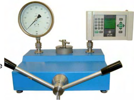
IBT400 mit Druckkalibrator und Prüfling
