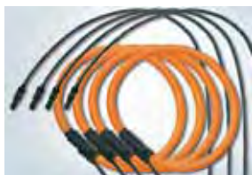
Jedes Modell hat 4 flexible Zangen für die Messung auch des Mittelleiterstroms
