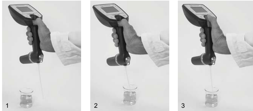
Abb. 12-1: Einfüllen der Probe mit dem Saugrohr
