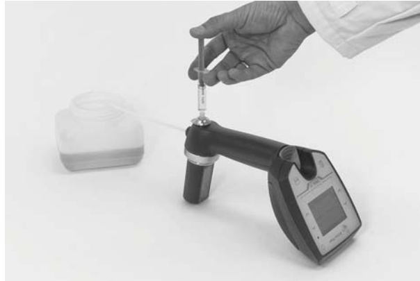
Abb. 12-2: Einfüllen der Probe mit einer Spritze
