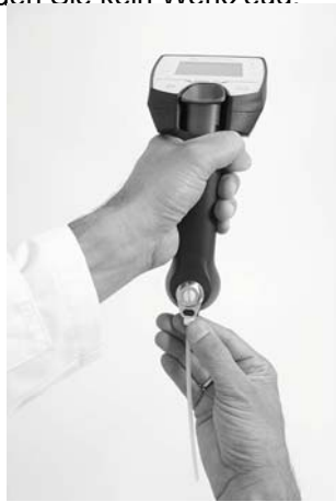
Abb. 6-1: Anschließen des Saugrohrs
