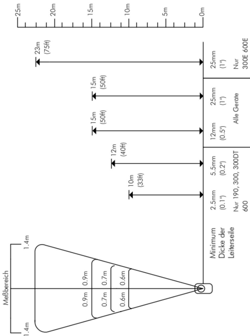
Das DT80 ist ein Zubehör zum KHM 300DT zum Messen von horizontalen oder vertikalen Entfernungen.
