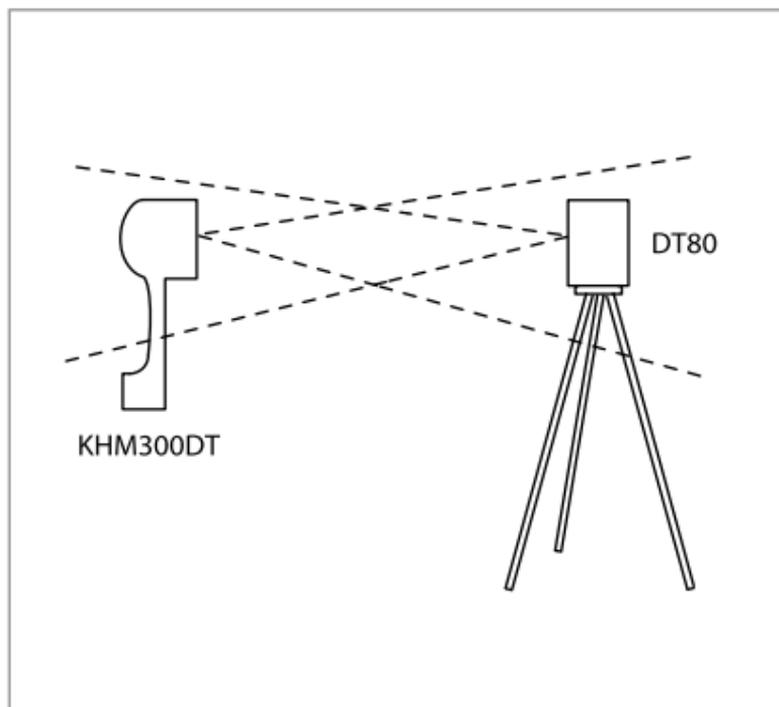
1. Positionieren Sie das DT80 an dem zu messenden Punkt. Beide Geräte können bei Bedarf mittels der im Boden eingelassenen Mutter auf einem Standardstativ befestigt werden.
