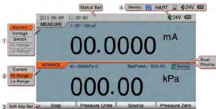
Abbildung 7. Zweibildschirmanzeige von Hauptbedienoberfläche
