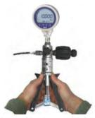
35 ... 40 bar können so recht schnell erzeugt werden. Über 40 bar sollte der Druck mit dem Feinregulier-Ventil erhöht werden.
